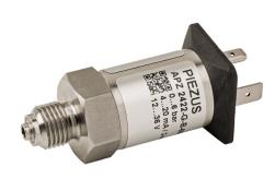
Датчик давления APZ 2422 серии OEM с погрешностью ≤0,5% от диапазона измерений предназначен для общепромышленного применения и объектов ЖКХ. Сенсор с разделительной мембраной из нержавеющей стали, установленный методом приварки, позволяет использовать этот датчик давления в промышленном холодильном оборудовании. Изготавливается в многодиапазонном исполнении. Для переключения диапазонов и корректировки нулевого значения используется конфигуратор ZCON 100 (поставляется отдельно).
