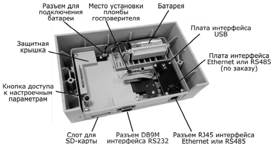
Рис. 2.2 – Вид снизу на приборный отсек ТВ7
