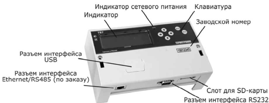
Рис. 2.1 – Внешний вид приборного отсека ТВ7 (вид сверху)
