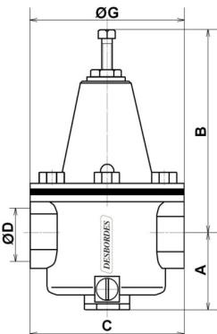
Габаритные и присоединительные размеры клапанов редукционных типа 10BIS.
