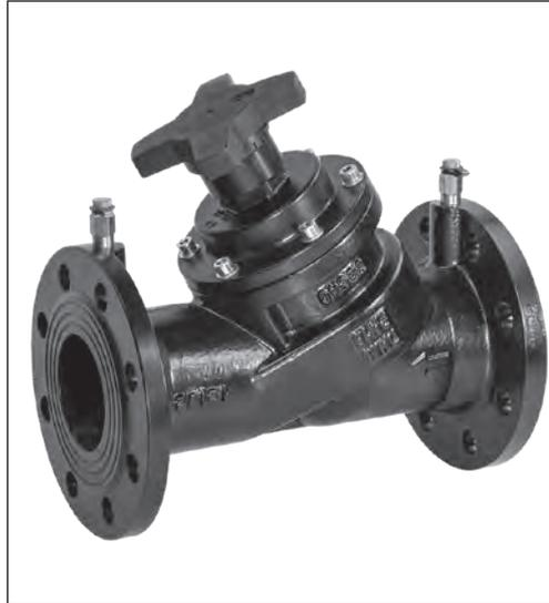
Ручной балансировочный клапан MNF-R предназначен для монтажной наладки трубопроводных систем тепло- и холодоснабжения для обеспечения в них расчетного расхода. Клапан позволяет менять и фиксировать пропускную способность, имеет удобный индикатор настройки.
