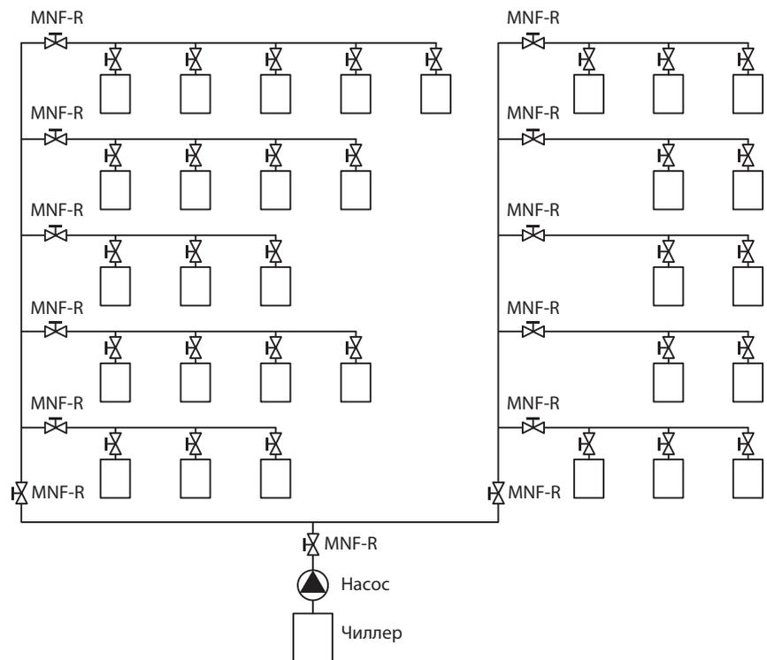
*Примечание.* Чтобы сбалансировать систему холодоснабжения с постоянным расходом ручные балансировочные клапаны должны быть установлены на каждом фанкойле, на каждой ветке, на каждом стоке и на общем магистральном трубопроводе.
